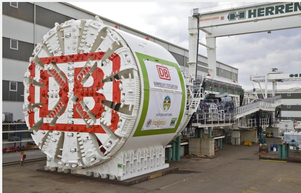
Beispiel einer Tunnelbohrmaschine für Bodenausbau in geschlossener Bauweise
